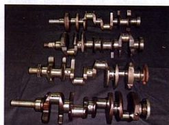
Kurbelwellen von groß (Ford 5.0 l) über größer (Ford 351c) bis ganz groß (Chevy 454 und Ford 460 big block)
