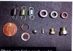
Oben, von links nach rechts: Zündungskomponenten - unterschiedliche Federn für die Zündkurve und Anschläge für die Festlegung der maximalen Frühverstellung.
