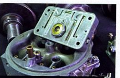
Im sog. Platineblock eines Holley Vergasers finden sich je nach Modell eine unterschiedliche Anzahl von Kanalverengungsbohrungen oder wechselbare Düsen. Abstimmungsarbeiten hier sind Profiterrain
